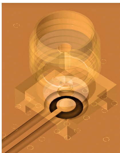
Рис. 7. Место установки коаксиального соединителя SMA
